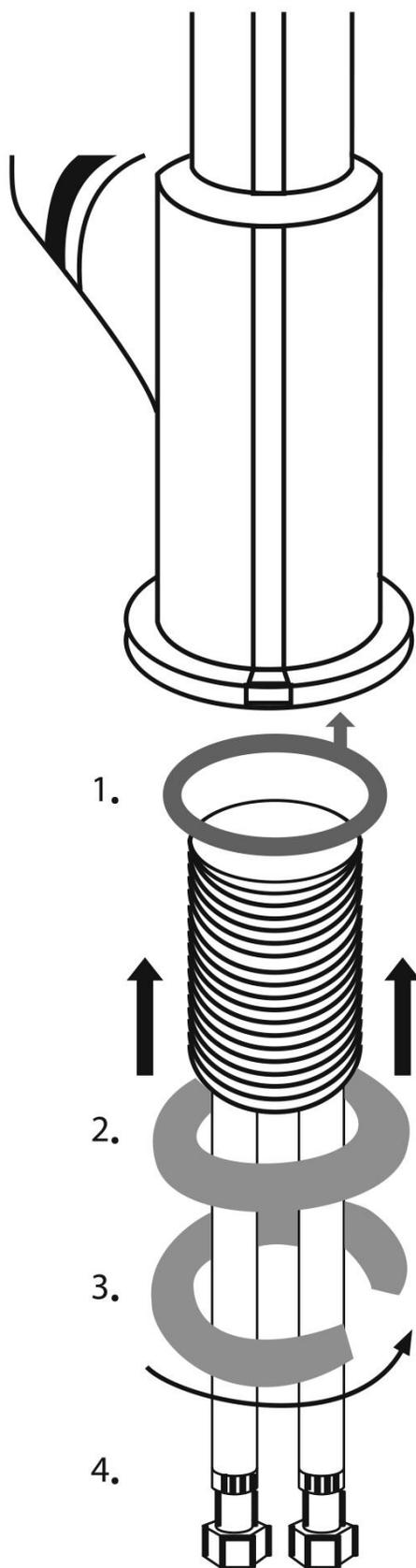
Такой способ монтажа подходит для всех смесителей торговой марки MAXONOR Pure Life, располагающихся на горизонтальных поверхностях кухонных моек (1;2;3) раковин (4;5), биде (6;7), имеющих гайку в качестве основного элемента крепления.
